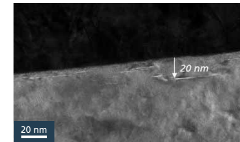
Transmissionselektronen- mikroskopische Querschnittsaufnahme einer ionenstrahlpolierten \text{CaF}_2 -Oberfläche
