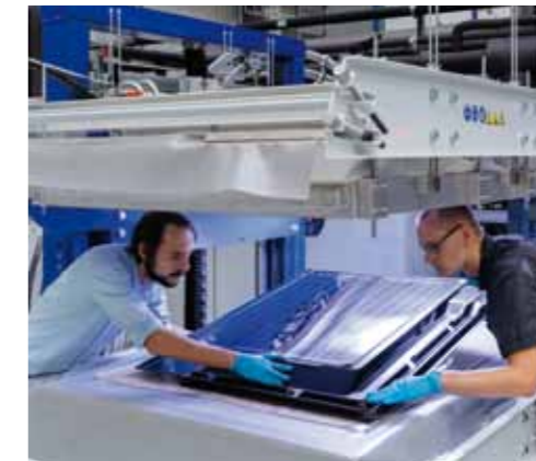
Das Fraunhofer CSP führt lebensdauerrelevante Untersuchungen der Stabilität der Modulverkapselung von Photovoltaik-Modulen durch.
