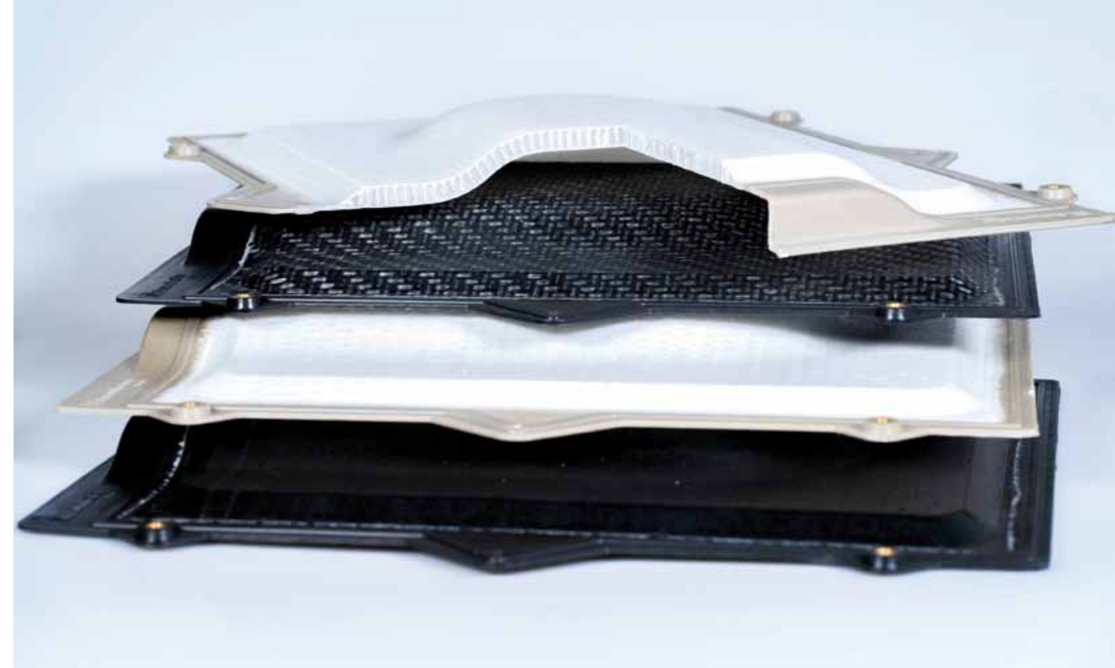
Im entwickelten Thermoformspritzgussprozess hergestellte Versuchsbauteile aus jeweils verschiedenartigen endlosfaserverstärktem Sandwichverbund.
